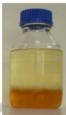
圖 2-1 轉酯化之生質柴油，上層為轉脂化之生質柴油，下層為粗製甘油。
