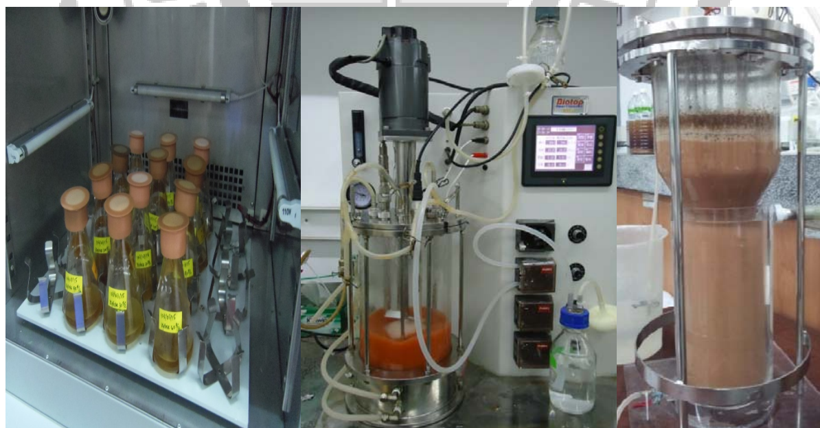
圖 2-3 左： Rhodotorula glutinis 之搖瓶培養裝置圖；中： Rhodotorulaglutinis 之攪拌式發酵槽裝置圖；右： Rhodotorulaglutinis 之氣舉式發酵槽裝置圖
