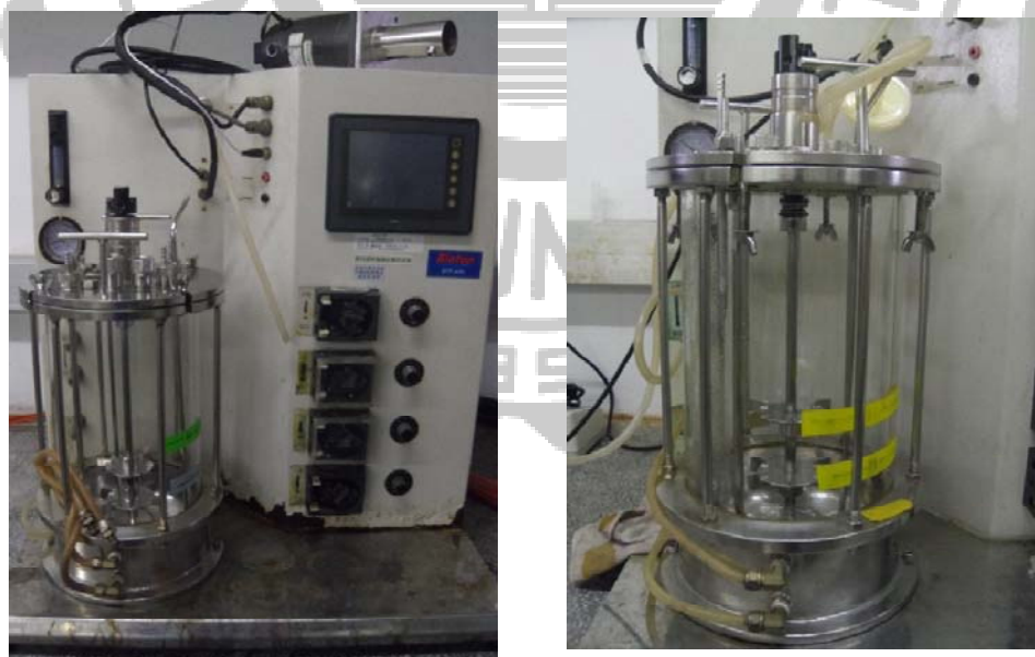
圖 3-2 攪拌式發酵槽
